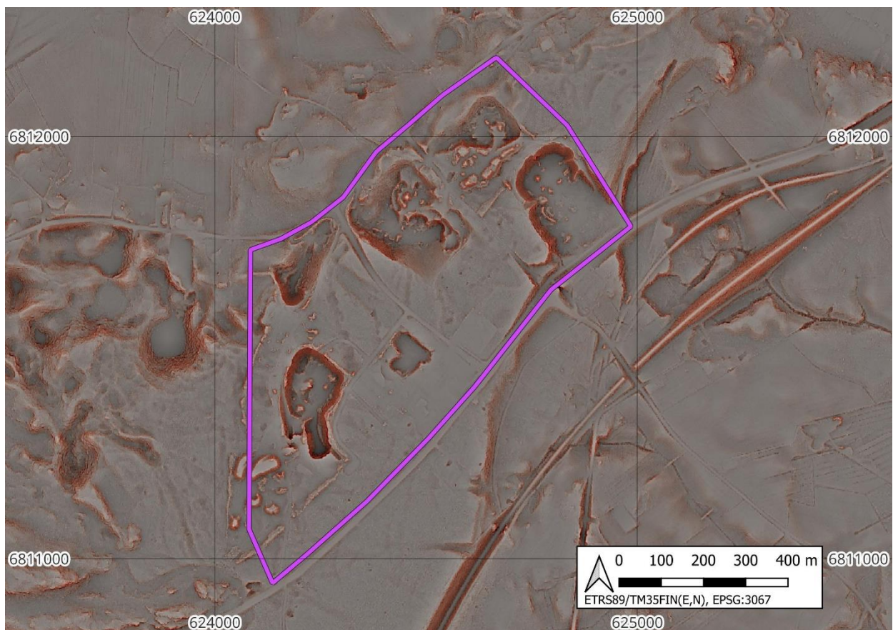
Kuva 7. Hankealueen korkeussuhteet Maanmittauslaitoksen laserkeilausaineiston (5 pistettä neliömetrille) perusteella.
